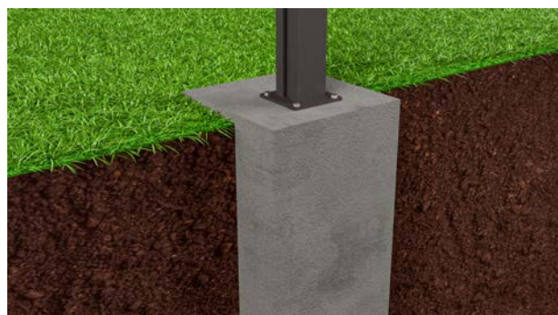
Montage mit Fußplatte auf Fundament
