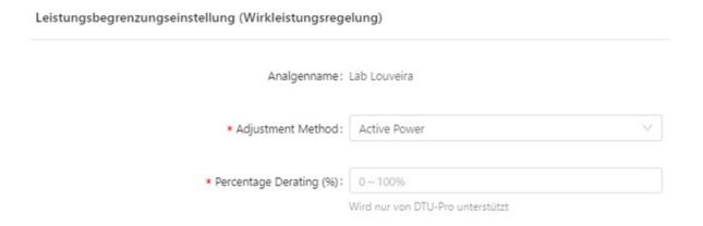
Bei Mikro-Wechselrichtern der 2. Generation beträgt der Einstellbereich 10 % bis 100 %. Bei Mikro-Wechselrichtern der 3. Generation beträgt der Einstellbereich 2 % bis 100 %.
