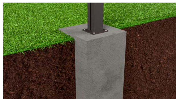
Montage mit Fußplatte auf Fundament
