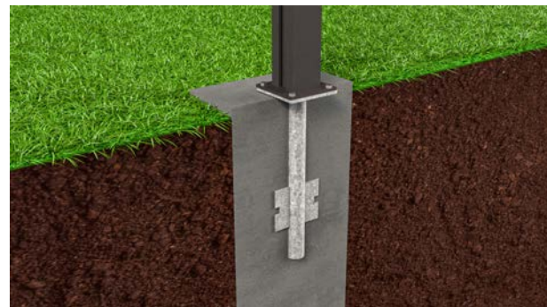
Montage mit Fußplatte auf Erdanker
